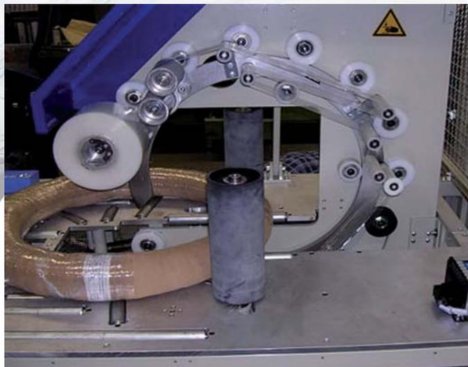
Vollautomatische Einwickelmaschine für Ringgut mit horizontaler Packgut-Aufnahme
